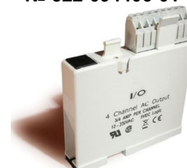
Модуль цифрового вывода сигналов перем. тока маячка, инв. № 322-094401-01
