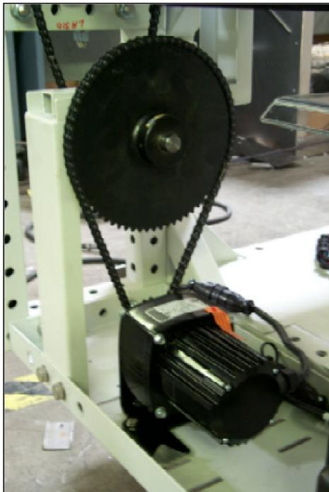
Рисунок 3-7: Электродвигатель ленточного конвейера
