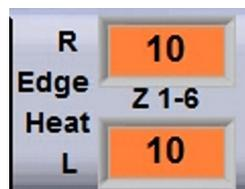
Figure 3-30 Edge Heater setpoints
